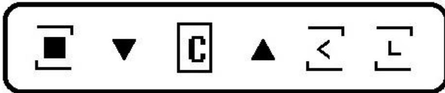
Nach 60 Betriebsstunden erscheint im LED Display die Anzeige „C“ (dieses steht für „Clean“), dabei handelt es sich um einen automatischen Timer der, unabhängig davon ob Sie die Filter gereinigt haben oder nicht, Sie aus Sicherheitsgründen an das Reinigen der Fettfilter erinnert.
